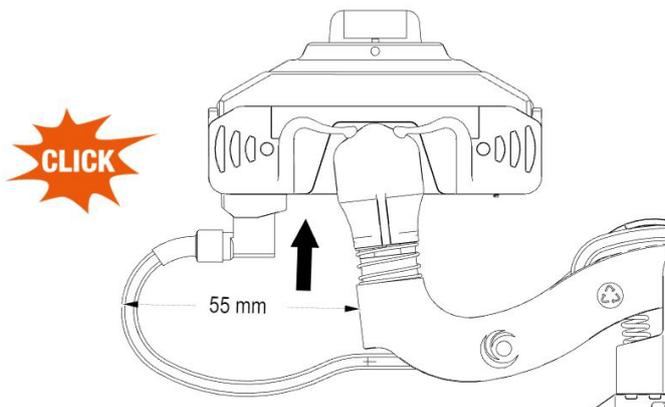
Fig. 187: Attach angled blade receptacle
