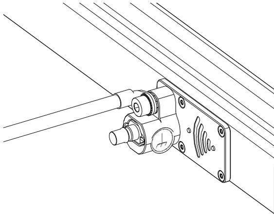
Fig. 136: Fully mounted equipotential bonding cable
